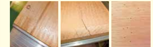
木目、割れ・傷(割れ幅2mm以内・非貫通) 虫食い
