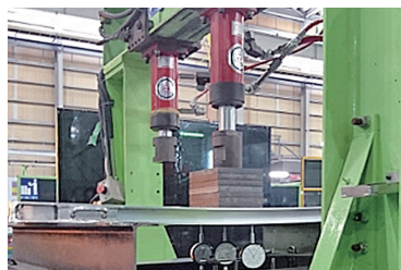
耐荷重2,500kg/枚 クリア (自社工場による強度確認試験実施) 走行試験は表面写真参照
