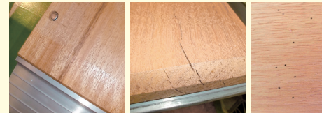
木目、割れ・傷 (割れ幅2mm以内・非貫通) 虫食い
